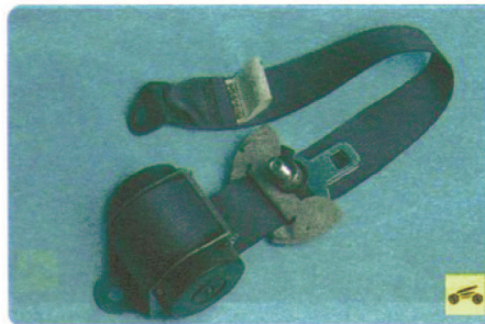
9. ...и отведите пряжку в сборе с ремнем от панели кузова.
